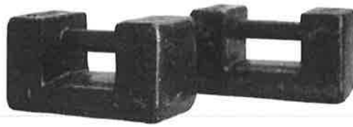
ตัวอย่าง ตุ่มน้ำหนักเหล็กมาตรฐาน น้ำหนัก 10 กิโลกรัม
