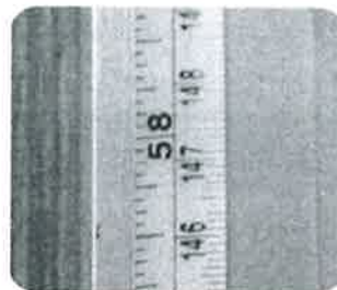
ความละเอียด 0.1 เซนติเมตร หรือ 1 เซนติเมตร แบ่งเป็น 10 ชิดย่อย
